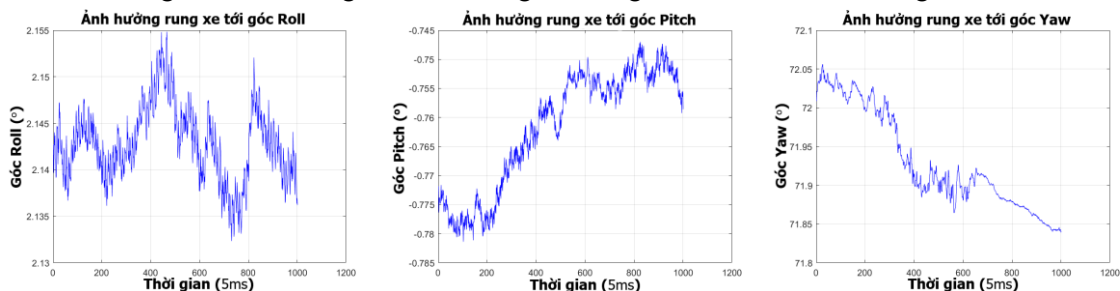
Hình 3. Ảnh hưởng của nhiễu rung xe tới tọa độ góc đường bắn.
