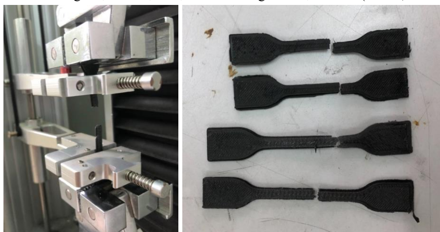
Hình 3. Thực nghiệm kéo sản phẩm sau in 3D.
