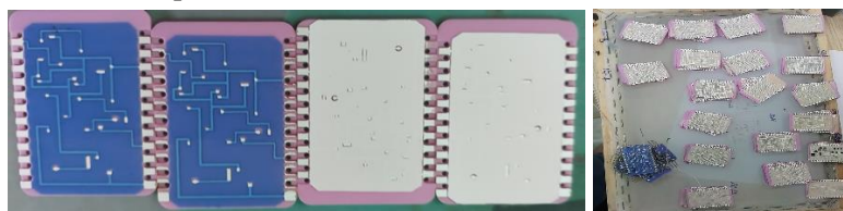
Hình 4. Kết quả thiết kế vi mạch tích hợp lai theo công nghệ màng dày.
