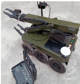
Hình 8. Tổ hợp thiết bị điều khiển từ xa dò bom mìn, vật nổ và có khả năng đào, xúc, gắp ở độ sâu đến 1,5 m.
