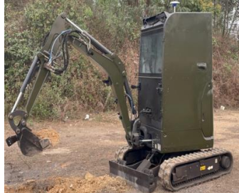
Hình 8. Tổ hợp thiết bị điều khiển từ xa dò bom mìn, vật nổ và có khả năng đào, xúc, gắp ở độ sâu đến 1,5 m.
