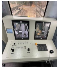
Hình 8. Tổ hợp thiết bị điều khiển từ xa dò bom mìn, vật nổ và có khả năng đào, xúc, gắp ở độ sâu đến 1,5 m.
