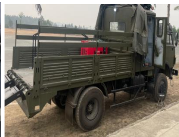
Hình 8. Tổ hợp thiết bị điều khiển từ xa dò bom mìn, vật nổ và có khả năng đào, xúc, gắp ở độ sâu đến 1,5 m.
