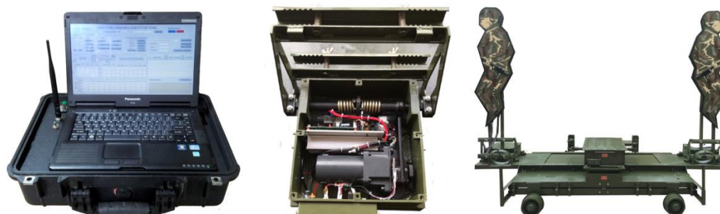
Hình 5. Hệ thống điều khiển máy bia và tự động báo kết quả bắn.
