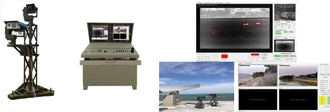
Hình 9. Hệ thống giám sát cảnh báo chống đột nhập bảo vệ căn cứ trên đảo.
