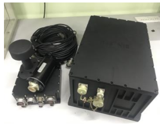
Hình 12. Khối dẫn đường quán tính cho xe bộ phóng của tổ hợp tên lửa Bastion.
