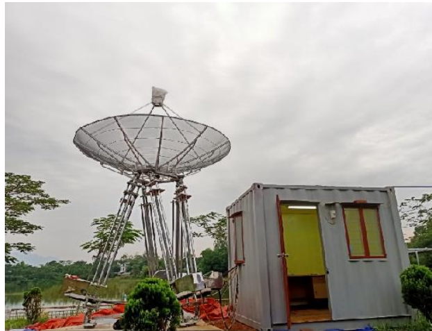
Hình 1. Một hệ thống anten vệ tinh sử dụng cơ cấu truyền động dạng Stewart Platform của Viện Hàn lâm khoa học Việt Nam [2-3].
