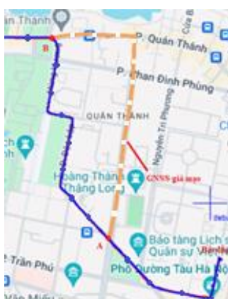
Hình 5. Kết hợp INS/Odometer với GNSS để phát hiện và sửa điểm giả mạo.
