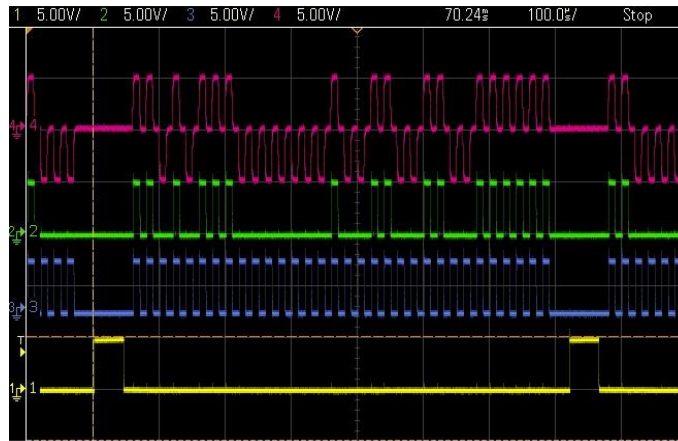
Hình 6. Giản đồ xung giải pháp thu tín hiệu theo chuẩn ARINC-429.
