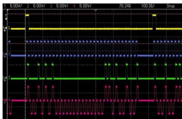
Hình 4. Giản đồ xung giải pháp truyền tín hiệu theo chuẩn ARINC-429.
