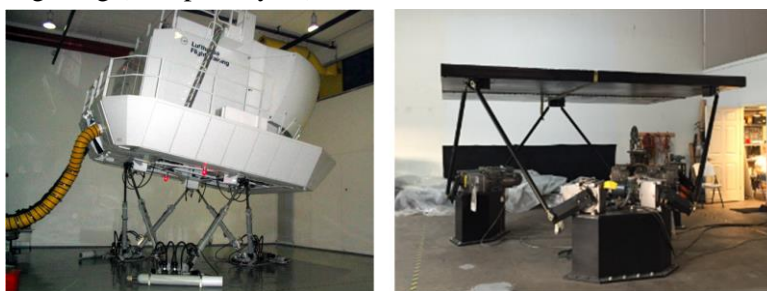
Hình 2. Cấu trúc bộ dạng tịnh tiến (trái) và dạng tay quay- thanh truyền (phải).
