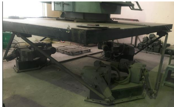
Hình 7. Bộ Stewart của hãng Servo and Simulation tại phòng thí nghiệm.
