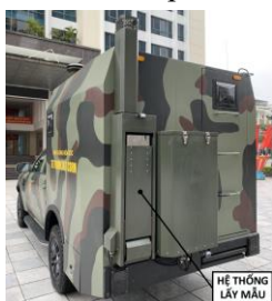
Hình 5. Tích hợp hệ thống lấy mẫu tự động lên xe trinh sát CBRN. Hình 6. Thực nghiệm vận tốc nâng hạ, cảm nhận độ cao địa hình.
