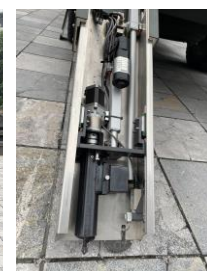
Hình 5. Tích hợp hệ thống lấy mẫu tự động lên xe trinh sát CBRN. Hình 6. Thực nghiệm vận tốc nâng hạ, cảm nhận độ cao địa hình.
