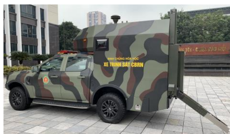
Hình 5. Tích hợp hệ thống lấy mẫu tự động lên xe trinh sát CBRN. Hình 6. Thực nghiệm vận tốc nâng hạ, cảm nhận độ cao địa hình.
