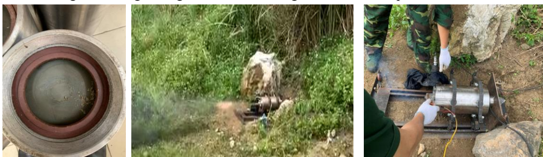
Hình 9. Thử nghiệm đốt trên giá động cơ hành trình.
