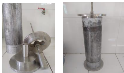
Hình 4. Bộ khuôn phủ lớp chống cháy.
