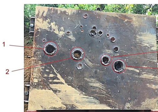
Hình 5. Kết quả thử khả năng xuyên thép với liều nổ được chế tạo từ khối nón có góc mở khác nhau.
