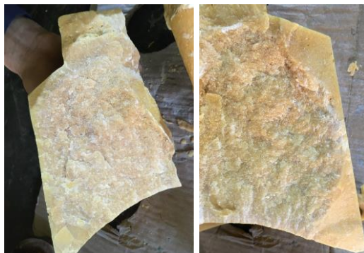
Hình 3. Liều nổ khi đúc ở 86 °C.
