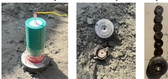
Hình 7. Thử nghiệm xác định chiều sâu xuyên của đạn xuyên lõm mẫu nhỏ.
