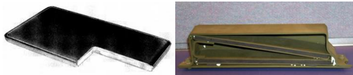
Hình 1. Phần tử nổ và modul GPUN kiểu Kontakt-1 với 02 phần tử nổ 4C20.
