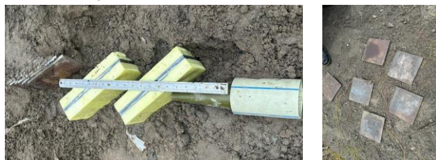
Hình 15. Thử nghiệm với 2 phần tử nổ.
