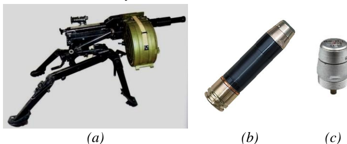
Hình 1. Súng AGS (a), đạn ĐLP (b) và ngòi NLP-17 (c).
