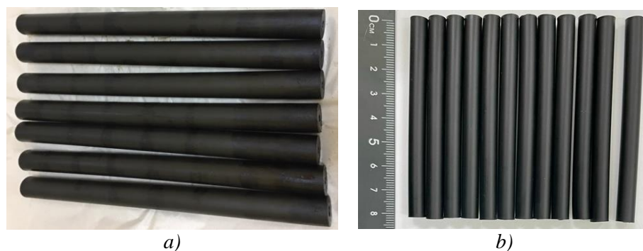
Hình 2. Mẫu thuốc phóng khảo sát của nước ngoài (a) và mẫu thuốc phóng Việt Nam chế tạo (b).
