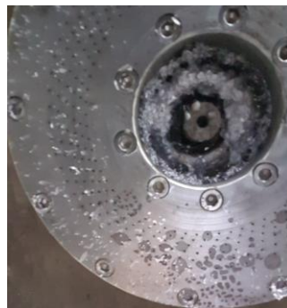
Hình 9. Sự tích tụ của kim loại lỏng tại vành khí phân tán và ống đồng gia nhiệt ( h = 1 cm).
