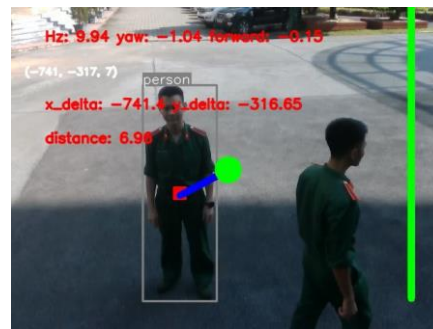
Hình 10. Thực nghiệm thuật toán điều khiển bám đối tượng kịch bản 2.
