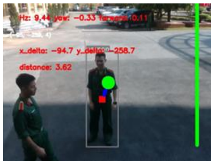
Hình 10. Thực nghiệm thuật toán điều khiển bám đối tượng kịch bản 2.
