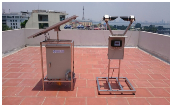
Hình 10. Hình ảnh thiết bị đo mưa chế tạo theo đề xuất cải tiến.
