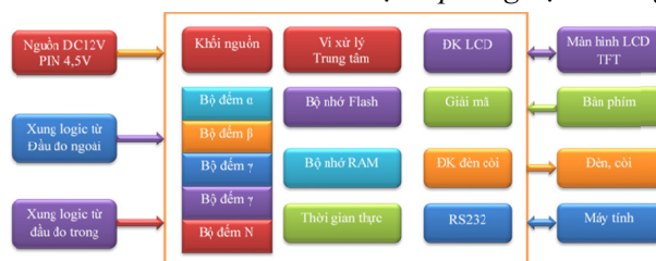
Hình 2. Sơ đồ khối chức năng của thân máy chính.
