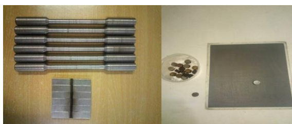
Hình 4. Các mẫu khảo sát ảnh tổ chức tế vi, mẫu thử kéo và mẫu thử độ dai va đập.
