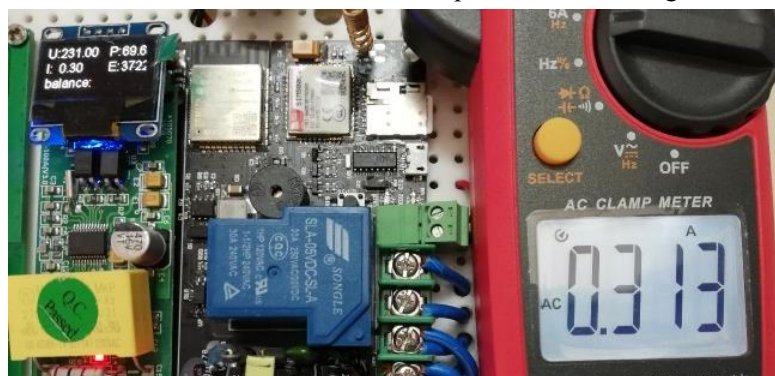
Hình 8. Kiểm nghiệm đo dòng điện.
