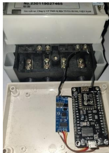
Hình 6. Mạch IoT kết nối công tơ điện tử.
