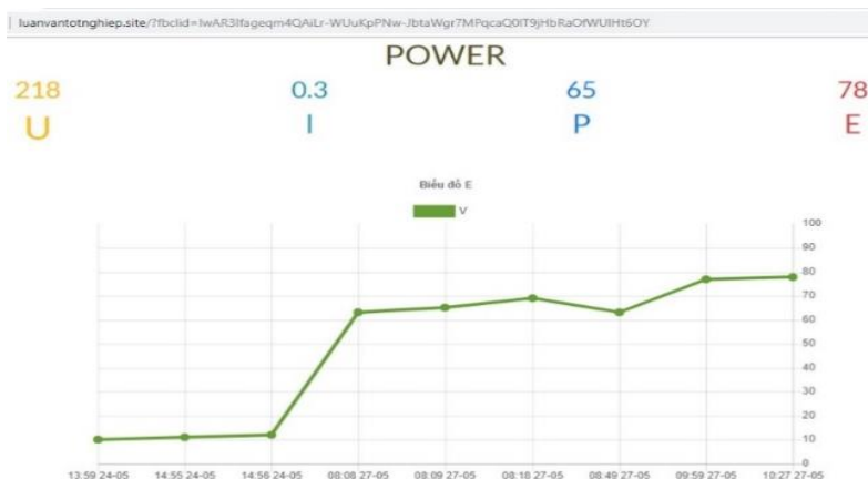
Hình 9. Giao diện giám sát các chỉ số điện hộ dùng công tơ điện cơ.
