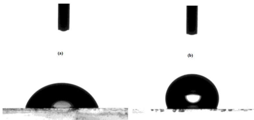
Hình 1. Hình ảnh góc tiếp xúc giọt nước của bề mặt kính trước (a) và sau (b) khi tạo màng phủ.
