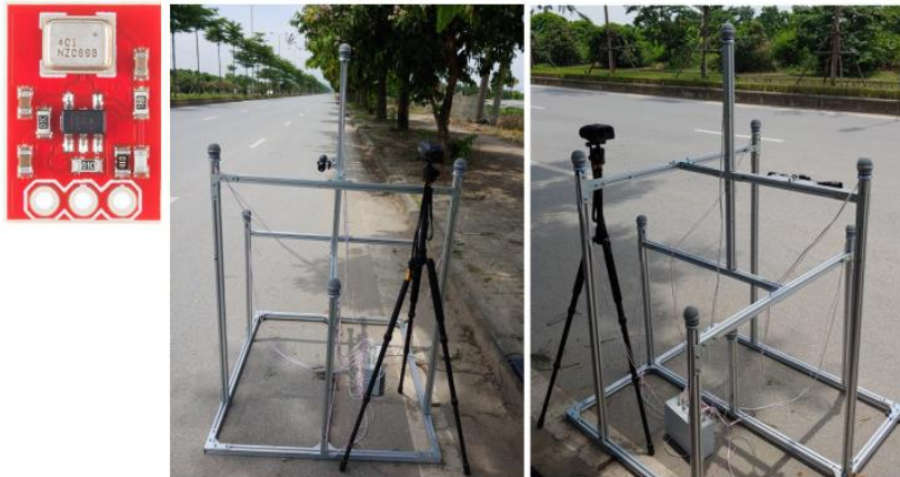
Hình 9. Cụm cảm biến thu tín hiệu âm thanh.
