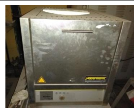
b) Lò xử lý nhiệt Nabertherm
