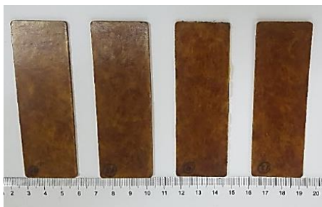
Hình 4. Hình ảnh mẫu composit phẳng trên cơ sở PF/T-11.
