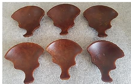
Hình 5. Hình ảnh đế BVN cho tên lửa B72 do nhóm nghiên cứu chế tạo.
