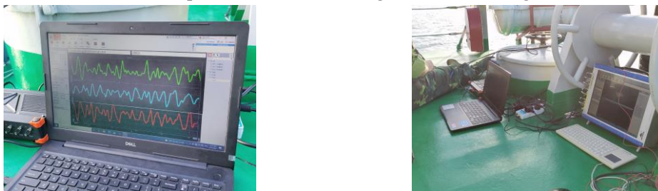
Hình 4. Hình ảnh kết quả đo đạc các dao động của tàu trên sóng trên tàu tuần tra ST-250.
