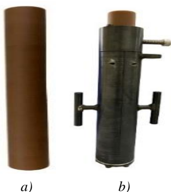
Hình 1. Hình ảnh thời nhiên liệu (hình 1a) và khuôn đúc vật liệu chống cháy lên thời nhiên liệu rắn ballistic RSI-12M (hình 1b).
