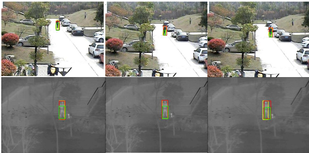
Hình 2. So sánh hiệu năng bắt bám đối tượng trên các nguồn ảnh khác nhau. Màu vàng kết quả chuẩn, màu xanh là bắt bám sử dụng ảnh nhìn thấy, màu đỏ sử dụng kết hợp ảnh nhìn thấy và ảnh nhiệt.
