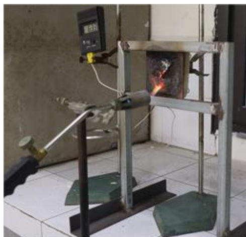
Hình 1. Thiết bị đánh giá khả năng bảo vệ của mẫu sơn chống cháy.
