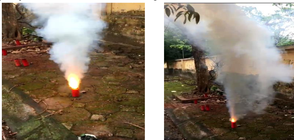
Hình 2. Quá trình cháy của cụm rít.
