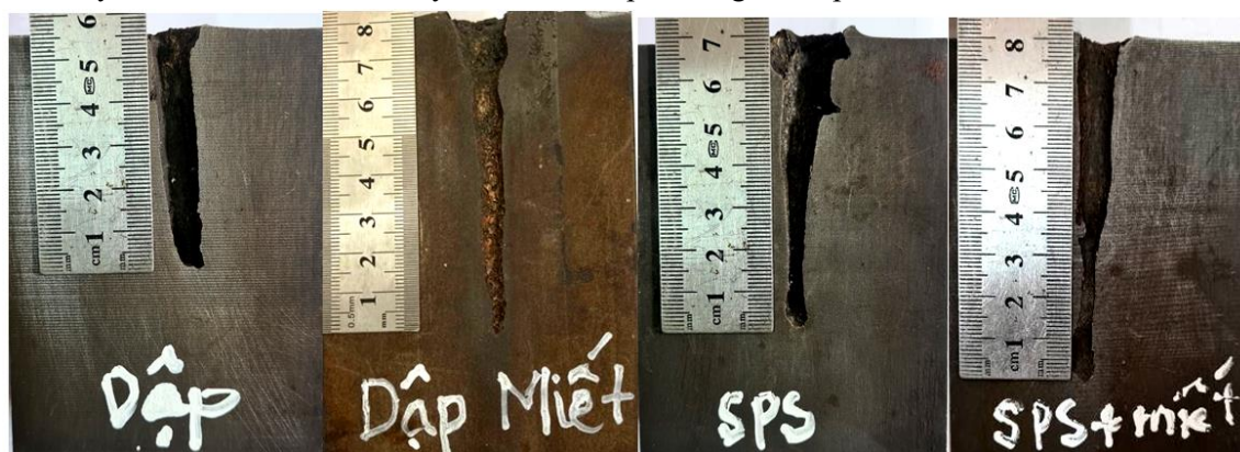
Hình 6. Hình ảnh mặt cắt lỗ xuyên trên bia sử dụng các loại phễu lót khác nhau.
