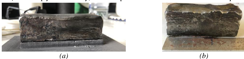
Hình 5. Thỏi đúc hợp kim 49K2ΦA được nấu từ (a) V sạch kỹ thuật, (b) FeV80.
