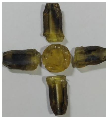
b) Thu hồi được sau khi bắn (tốc độ đầu nòng đo đạc được là 615 m/s)
