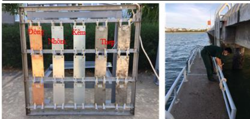
Hình 1. Các mẫu kim loại trước khi thử nghiệm và khu vực cầu cảng ngâm mẫu thuộc Lữ đoàn M/BTL Vùng 2 Hải quân.
