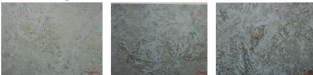
2 giờ 4 giờ 6 giờ Hình 4. Tổ chức tế vi hóa già 490°C thời gian khác nhau.
