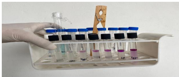
Hình 5. Hình ảnh mẫu blank và mẫu thử ở dải nồng độ 150 ppb, 350 ppb, 750 ppb, 1 ppm, 2 ppm, 5 ppm.
