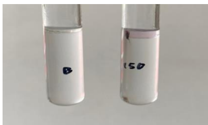
Hình 2. Màu sắc của mẫu blank và mẫu chất phân tích nồng độ 150 ppb.
