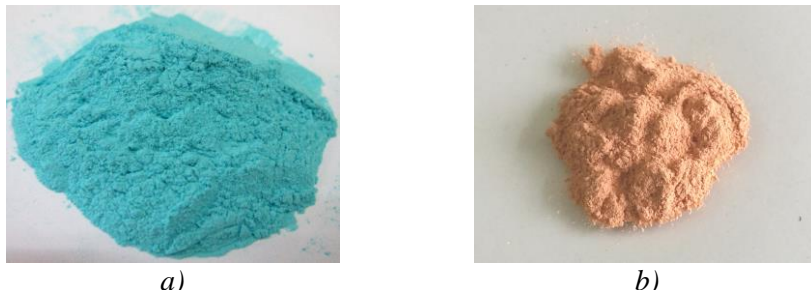
Hình 5. Vật liệu khung cơ kim sau khi chế tạo: a) CuBTC; b) FeBTC.
