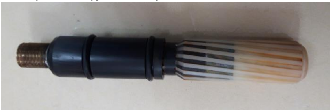
Hình 3. Ca-tốt được chế tạo dùng để gia công rãnh xoắn nòng pháo 30 mm.
