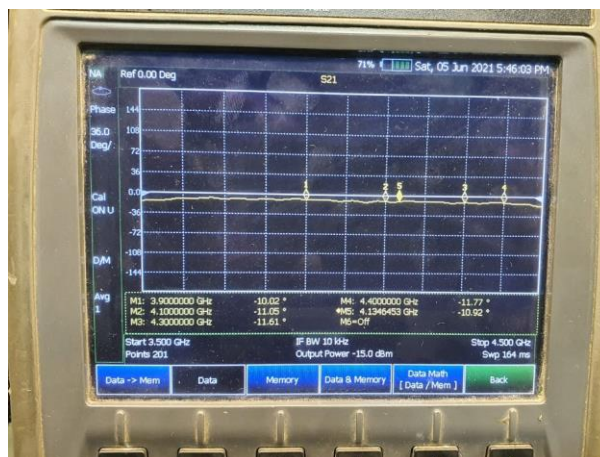
c) Kết quả đo độ lệch pha giữa các trạng thái của bộ xoay pha trên máy phân tích mạng.
