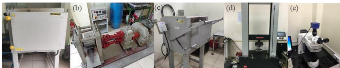
Hình 4. Các thiết bị thí nghiệm: (a) Lò LH120/13; (b) Máy cán D200; (c) Lò nung Nabertherm N31/H; (d) Máy thử kéo DEVOTRANS; (e) Kính hiển vi Axio Imager A2M - Đức.
