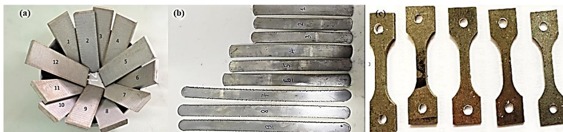
Hình 2. Mẫu hợp kim nhôm độ bền cao B95: (a) Trước khi cán; (b) Sau khi cán; (c) Mẫu thử kéo.
