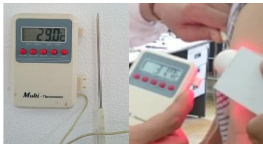
Hình 6. Ảnh kiểm tra sự tăng nhiệt trên bề mặt soi chiếu của thiết bị BKA-06.
