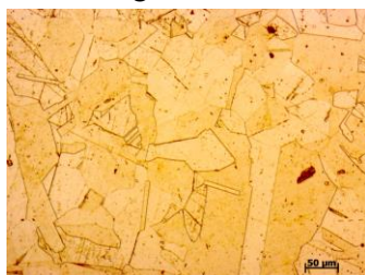
Hình 3. Tổ chức của mẫu thép không gỉ 316L sau khi ủ đồng đều hóa.
