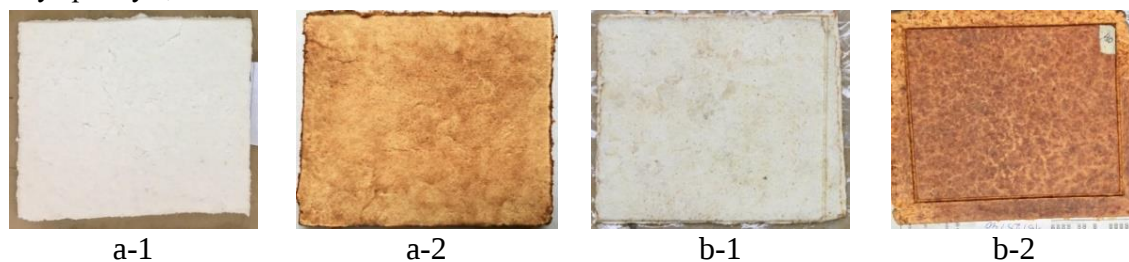
Hình 2. Tấm sơ bộ không có (a-1) và có TNT (a-2); Tấm mẫu sau khi ép không có (b-1) và có TNT (b-2).
