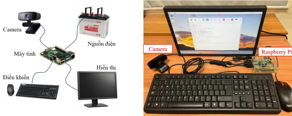
Hình 2. Ảnh tổng thể của hệ thống bắt bám dựa trên Raspberry Pi.
