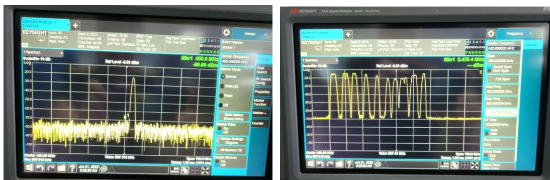
Hình 6. Phổ tín hiệu nhảy tần đối với mạch sử dụng IC Sx 1278:
