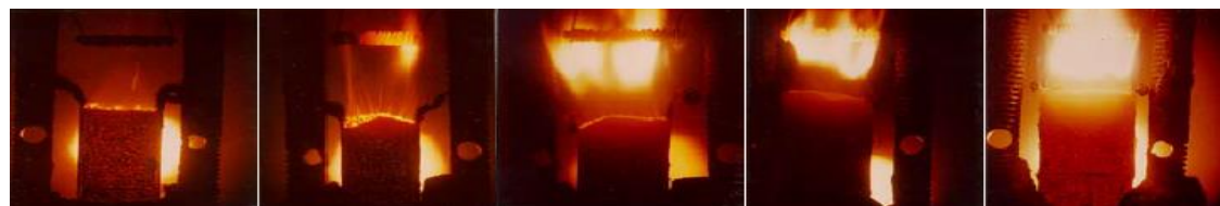
Hình 1. Hình ảnh thuốc phóng cháy tại các áp suất khác nhau [2].
